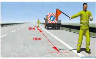
3 - gli operatori attraversano la carreggiata e posizionano i segnali sulla corsia di sorpasso.
