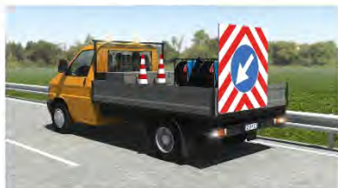
IL MEZZO DI TRASPORTO DEI SEGNALE STRADALI TEMPORANEI DA POSIZIONARE DEVE ESSERE DOTATO DI LAMPEGGIANTI GIALLI E SUL SUO RETRO DEVE ESSERE POSTO IL CARTELLO PASSAGGIO OBBLIGATORIO PER VEICOLI OPERATIVI (FIGURA II 398)
