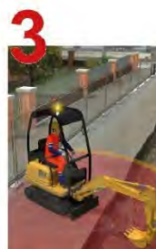
NON SOSTARE E/O PERCORRERE LE ZONE DI MANOVRA E DEL RAGGIO DI AZIONE DEI MEZZI D'OPERA E DI TRASPORTO
